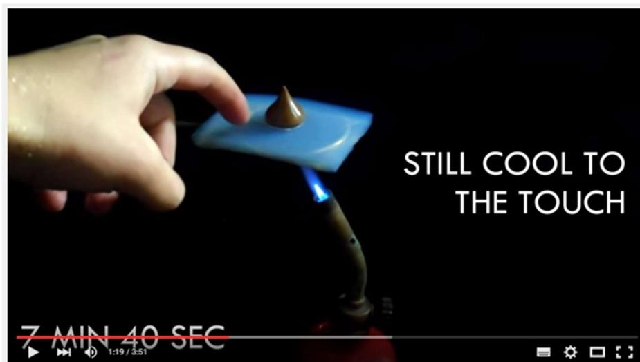
Figura 3.4 Aerogel calentado [14]
