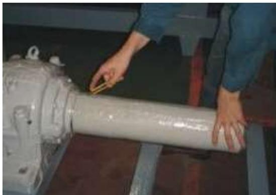
**Figura 3.8 Eje envuelto en Enviropeel [16]**
