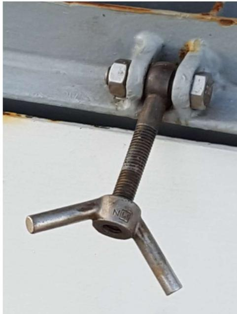
**Figura 2.5 Cierre de trinca**
