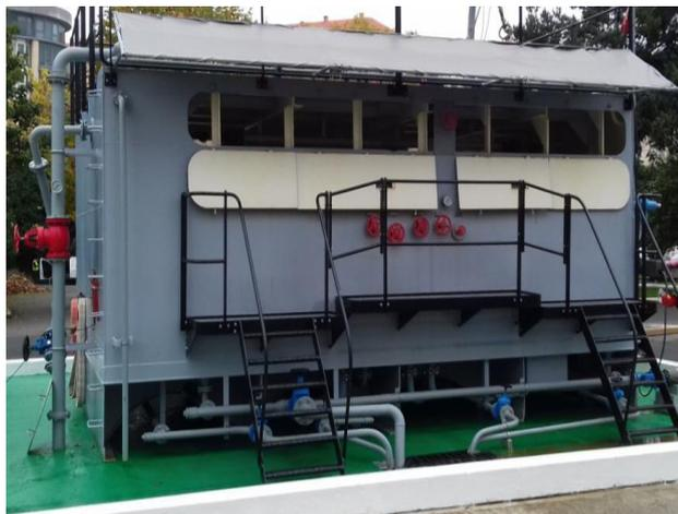
**Figura 2-13 Estructura para adiestramiento de control de averías**
