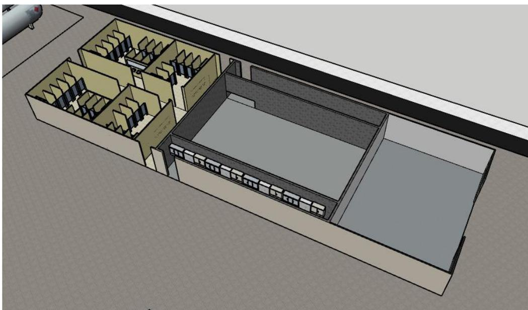
**Figura 4-4 Planta baja del adiestrador de fuegos interiores modelada en SketchUp**
