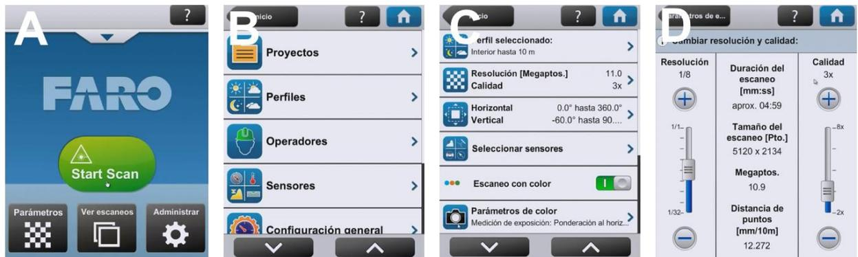
**Figura 3-8** Interfaz de la pantalla del láser escáner. (A) Menú principal; (B) Modo "administrar"; (C) Modo "parámetros"; (D) Submodo "resolución y calidad"
