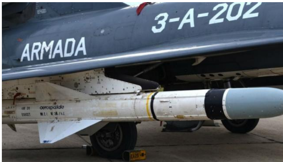
Figura 1-4 Misil Exocet AM39 en un avión de caza Super Etendard de la Armada Argentina (Fuente: Revista general de Marina)
