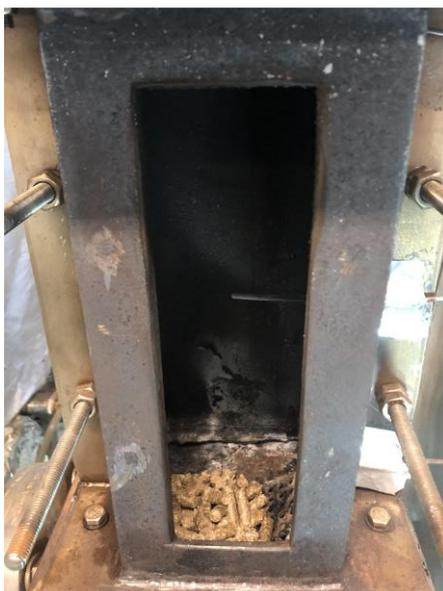
**Figura 5-4 Entrada de pellet en la cámara de alimentación**
