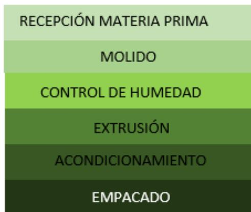
Figura 3-2 Etapas de fabricación de pellet. Fuente: elaboración propia
