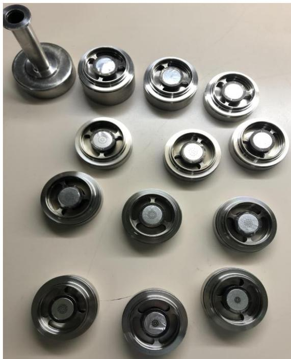
**Figura 4-12 Escalas del impactador tras un ensayo**
