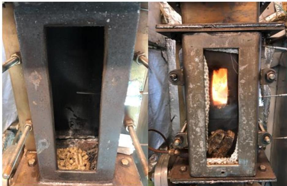
**Figura 4-6 Cámara de combustión abierta (izquierda) y cerrada (derecha)**
