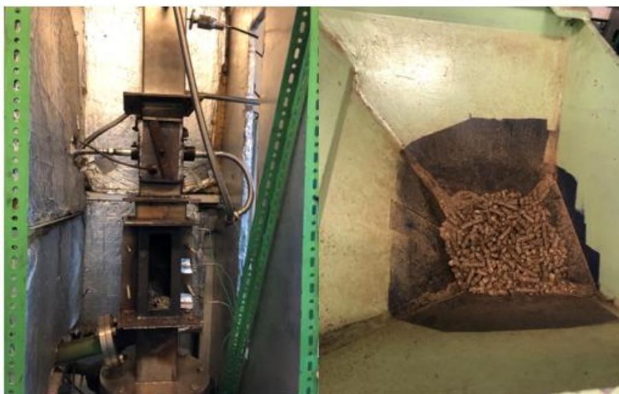
Figura 4-1 Instalación experimental: Módulo de combustión (izquierda) y Tolva con pellet (derecha)
