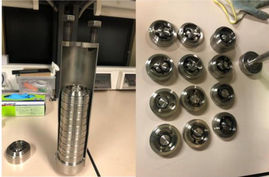
**Figura 4-11 Impactador (izquierda) y escalas del impactador (derecha)**
