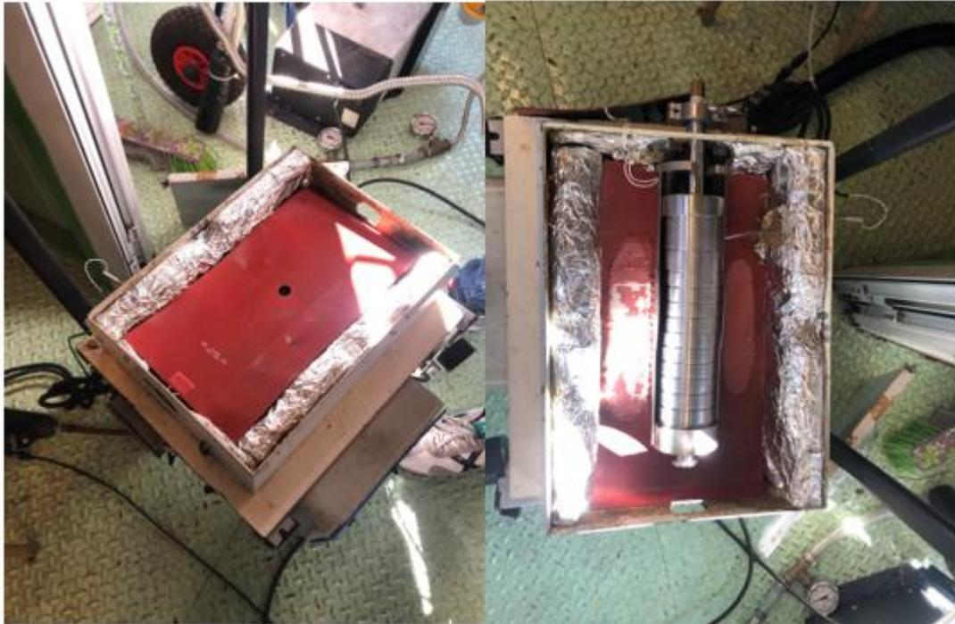
**Figura 4-14** Caja calefactora (izquierda) y caja calefactora con impactador (derecha)
