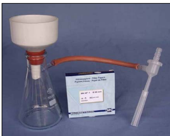
Figura 3-5 Unidad de filtrado al vacío
