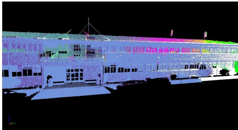
Figura 17 Resultado del registro de las nubes de puntos obtenidas para el modelado exterior del edificio
