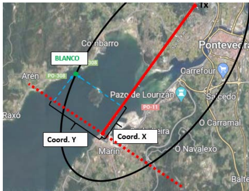
Figura 3-19 Coordenadas "X" e "Y" respecto de la línea base
