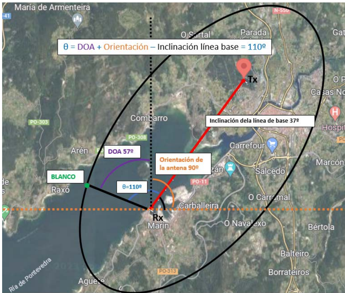
Figura 3-14 Cálculo de \theta con inclinación de la línea base [AP]
