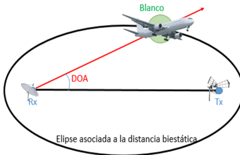
Figura 2-20 Determinación de blanco mediante elipse y DOA [AP]
