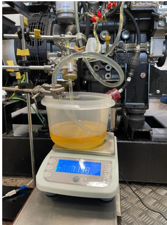
Figura 3-6: Depósito auxiliar de combustible con balanza digital para medición de consumos (autoría propia).
