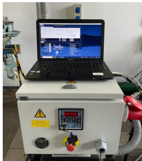
Figura 3-3: Controlador SAM conectado a un ordenador (autoría propia).
