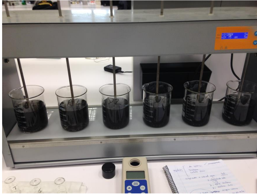
Figura 3-5 Muestras al finalizar el proceso de test de jarras controlado por rev/min y tiempo.
