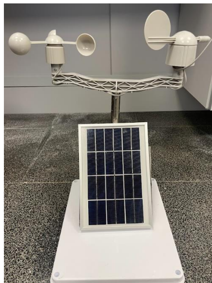
Figura 3-22 Sensores de viento y placa solar sobre la caja. Fuente: propia
