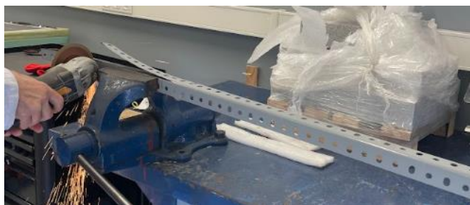
Figura 3-19 Corte del perfil de estantería usado para realizar el soporte. Fuente: propia
