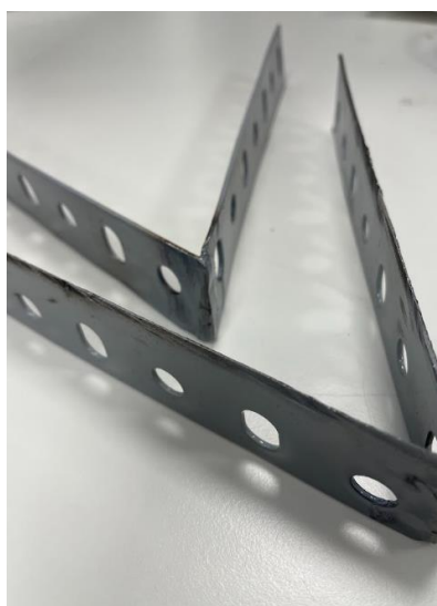
Figura 3-20 Perfil de estantería soldado a 60^\circ para realizar el soporte. Fuente: propia
