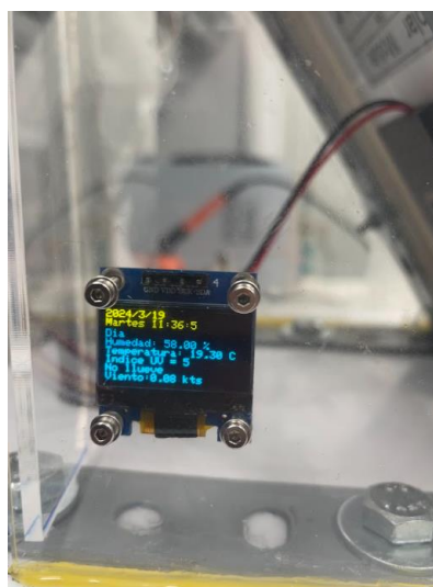
Figura 3-24 Pantalla OLED fijada al metacrilato. Fuente: propia
