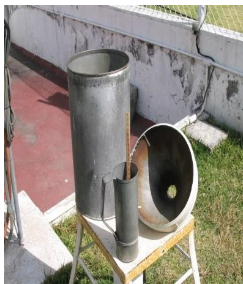
Figura 2-13 Ejemplo de pluviómetro
