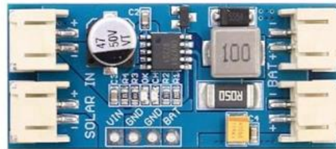
Figura 3-9 Módulo solar CN3791. Fuente: propia
