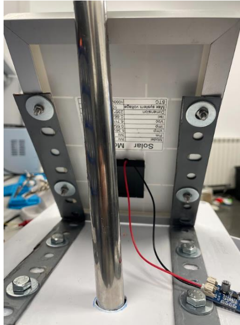
Figura 3-21 Orificio de entrada de los sensores de viento en la caja. Fuente: propia
