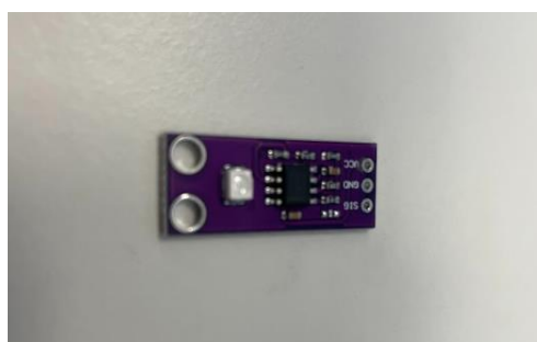
Figura 3-7 Sensor luz ultravioleta GUVA-S12SD. Fuente: propia
