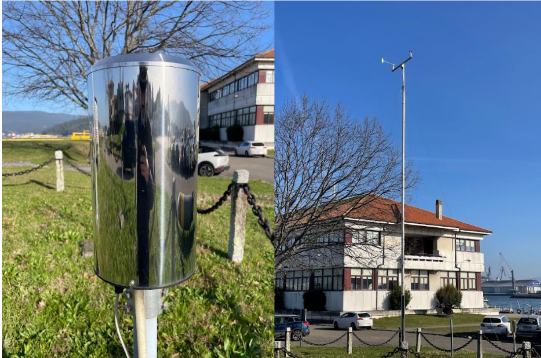
Figura 2-8 Oficina Meteorológica de Defensa, ENM (Derecha: pluviómetro. Izquierda: anemómetro y veleta). Fuente: propia
