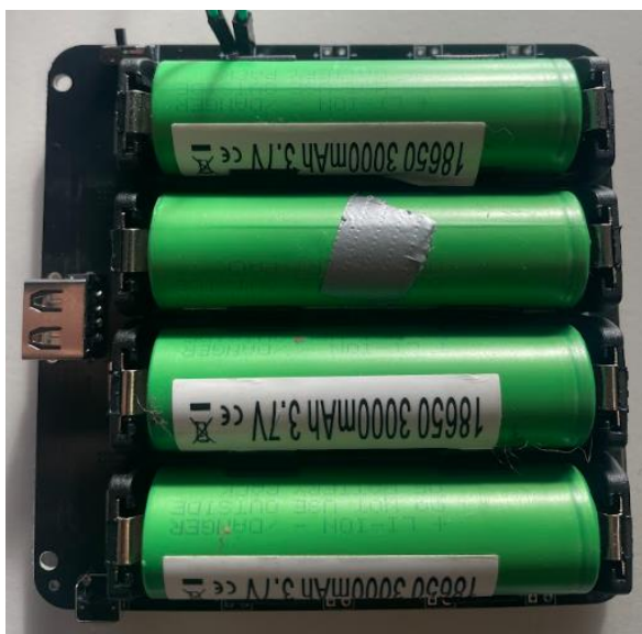
Figura 3-10 Baterías de litio 18650 en su soporte. Fuente: propia
