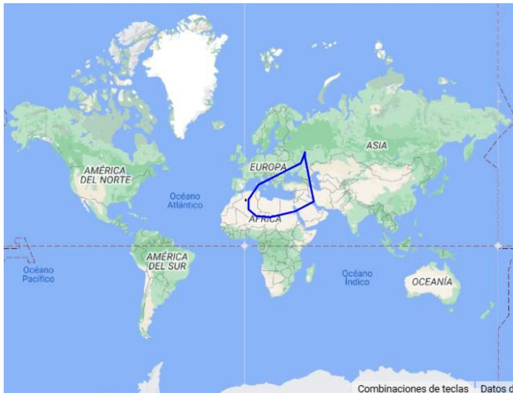
Figura 3-26. Diagrama aproximado de haz regional ( $4^\circ$ ) sobre la posición  $35N, 29E$  (calculado con [66]).
