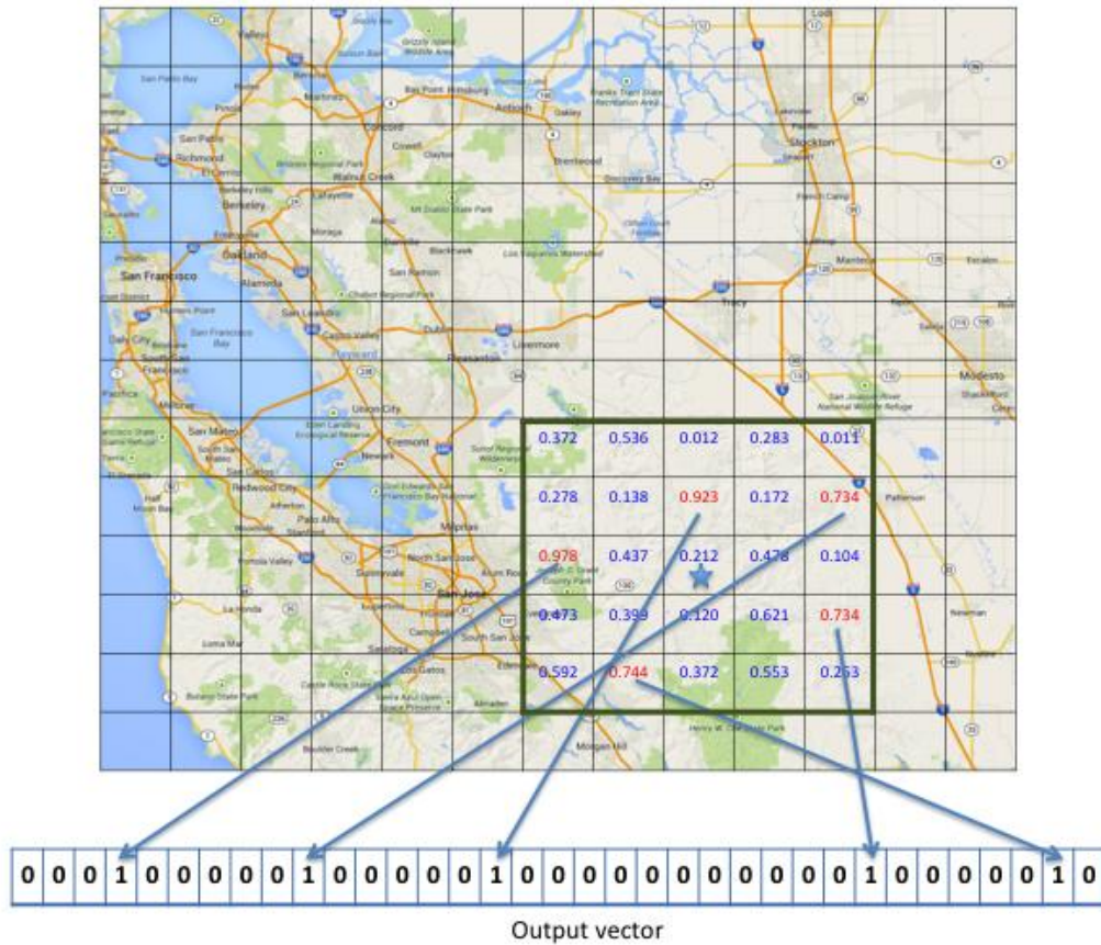
Figura 2-8 Generación de una SDR a partir de una entrada de latitud, longitud y velocidad por el codificador de coordenadas geoespaciales (fuente: [43]).
