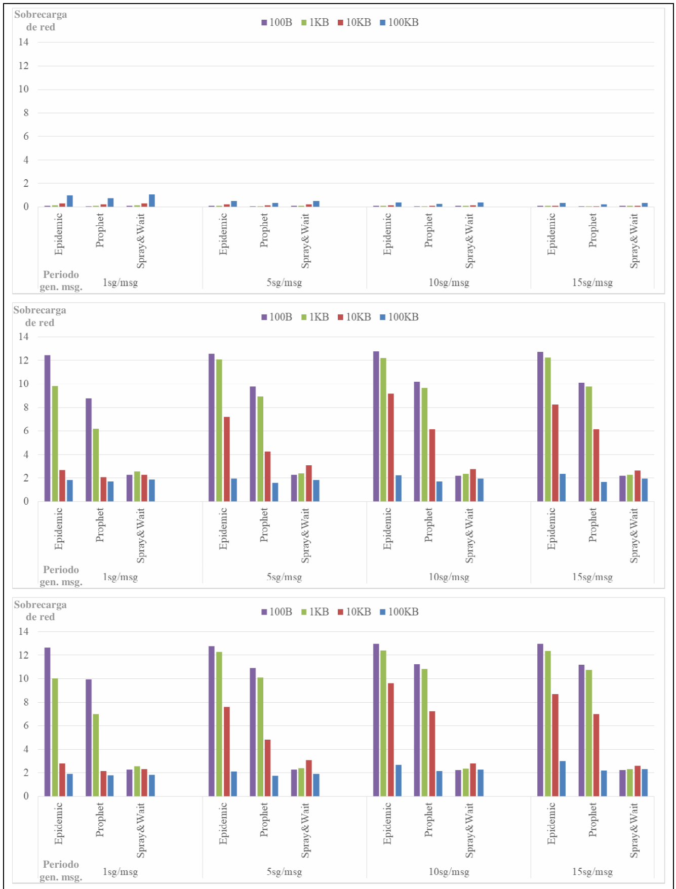
Figura 4-2 Representación del parámetro overhead_ratio en función de las 4 variables consideradas en las simulaciones (arriba TTL=1, medio TTL=3, abajo TTL=5)
