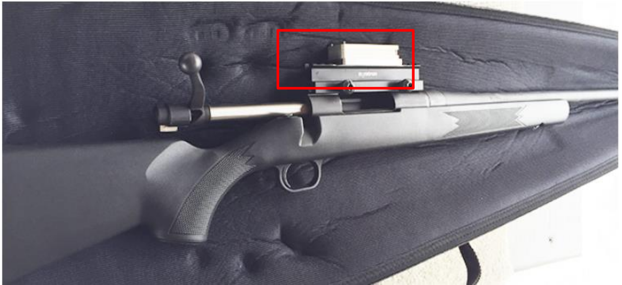
Figura 2-10 Ejemplo de sensor de aceleración [16]
