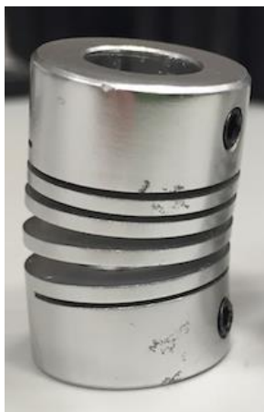
Figura 4-3 Acople flexible deformado
