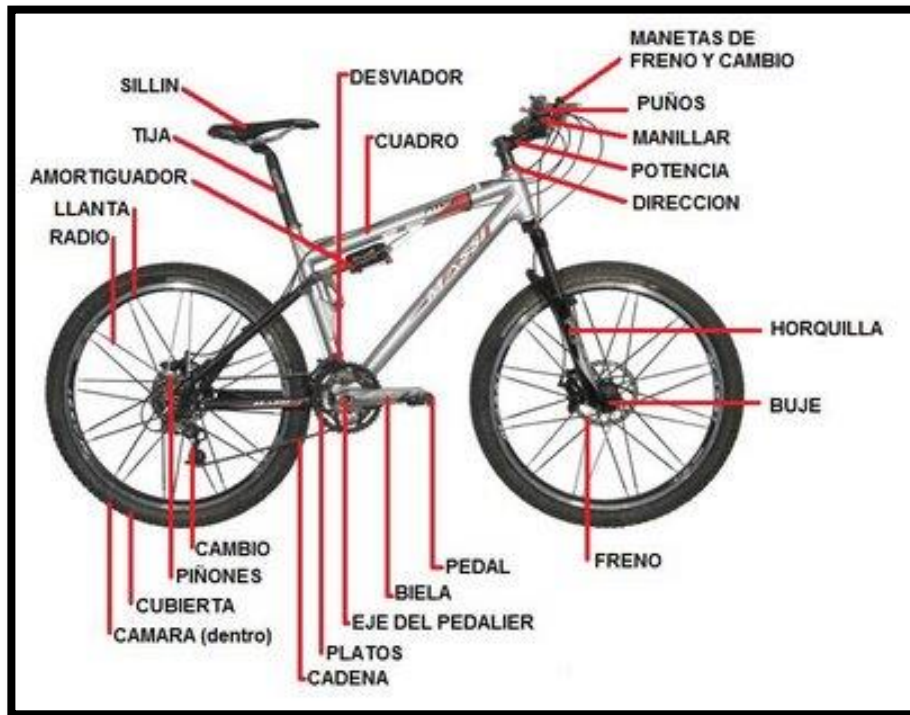
Figura 2-8 Partes de una bicicleta ( www.todomountainbike.es )
