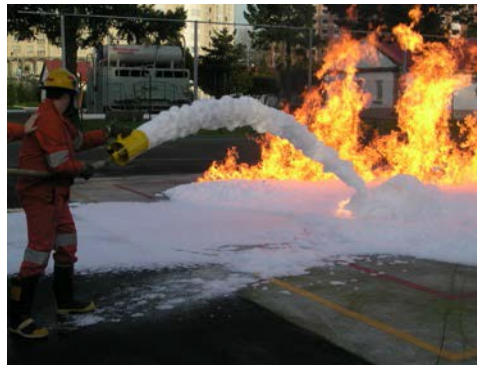
Figura 2-4 Extinción por separación del agente oxidante y el combustible. [7]
