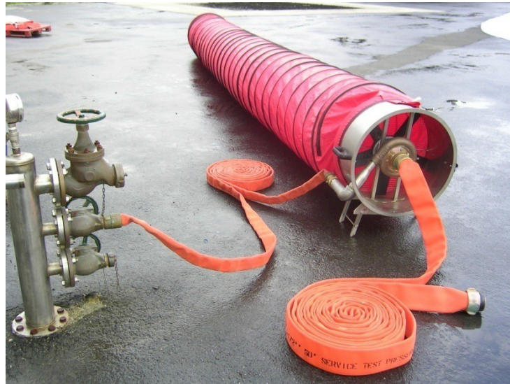
Figura 2-26 Excel en modo extractor de humos [9]
