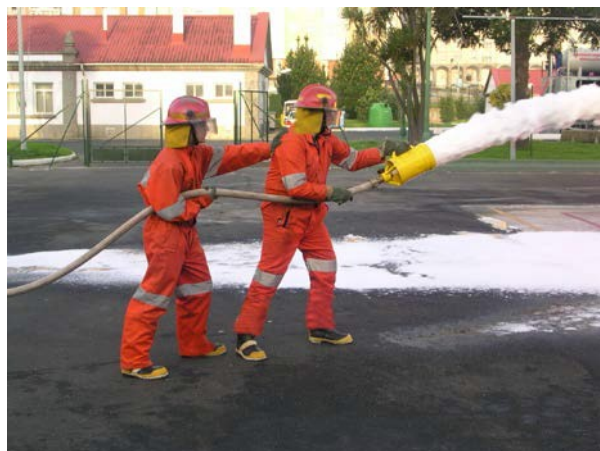
Figura 2-12 Aplicación de espuma de media expansión con una lanza de espuma M-2 [7]
