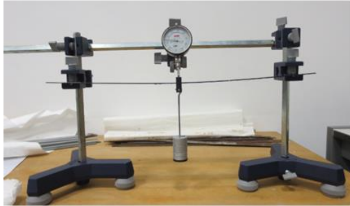
Figura 3-12 Montaje "Determinación del Módulo Elástico"
