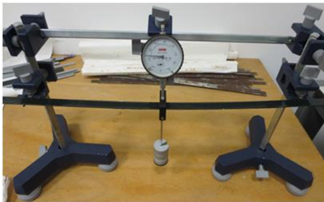
Figura 3-13 Ensayo de flexión pieza 11
