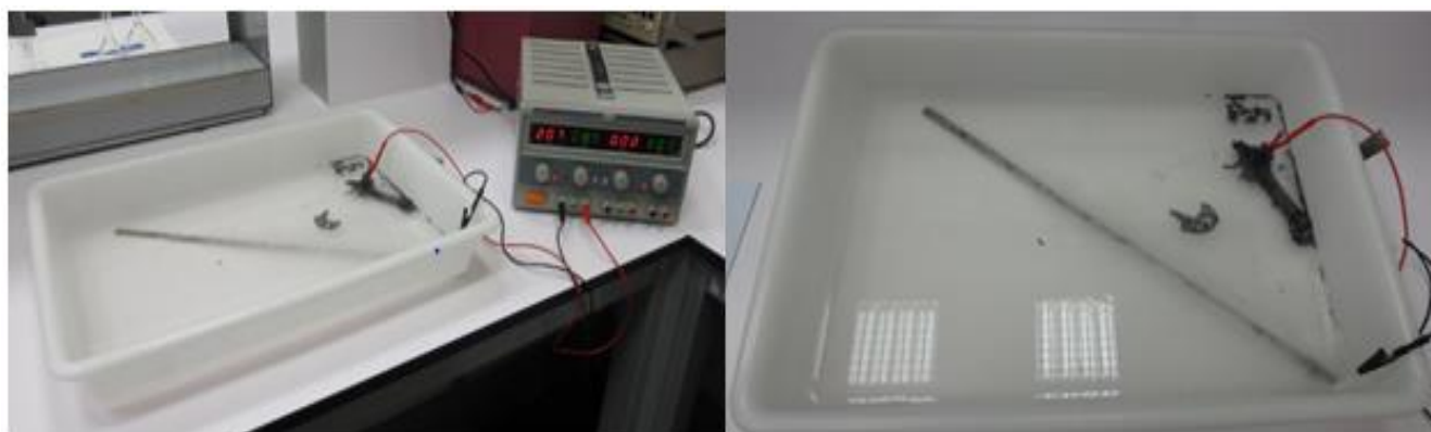
Figura 3-7 Montaje de Celda Electrolítica
