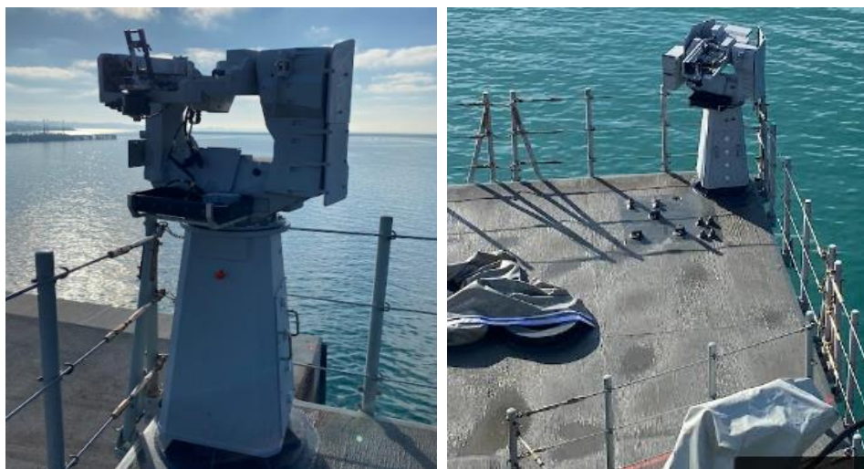
Figura 4-7 Ubicación RWS 12,7 mm en cubierta
