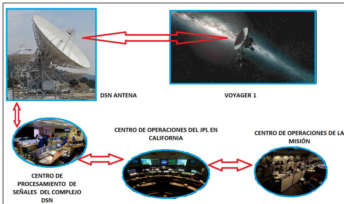
Figura 3-3 Esquema de trabajo de la DSN de la NASA
