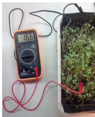
Figura 3-13 Ejemplo de toma de datos en la celda 1 con el multímetro digital.
