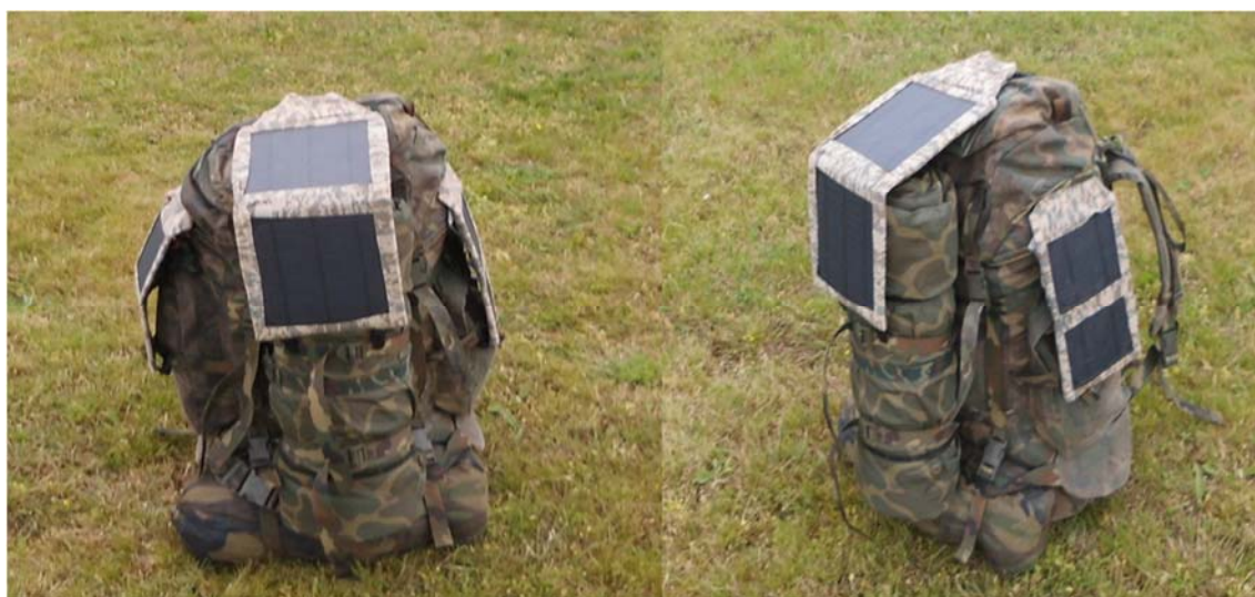
Figura 3-12 Paneles Fotovoltaicos colocados en mochila logística
