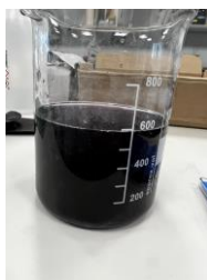
Figura 3-28 Vaso de precipitados con carbón activado y disolución contaminada
