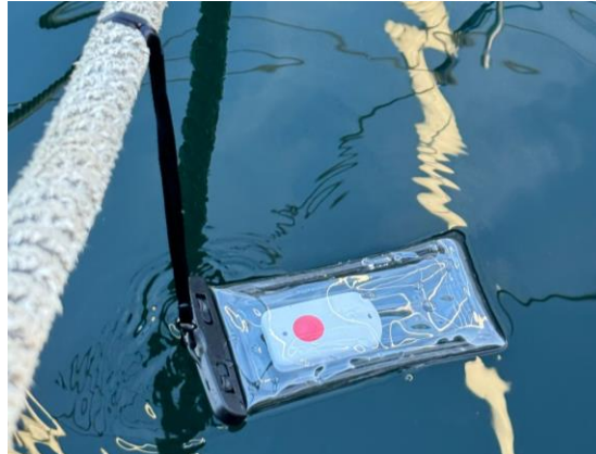
Figura 4-2 Prueba de estanqueidad en la dársena
