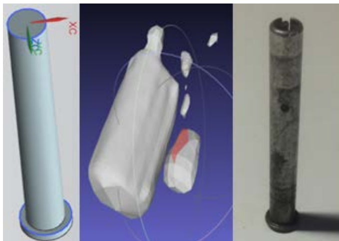
Figura 4-1 Comparativa entre diseño CAD, sólido obtenido con Ciclop y perno original
