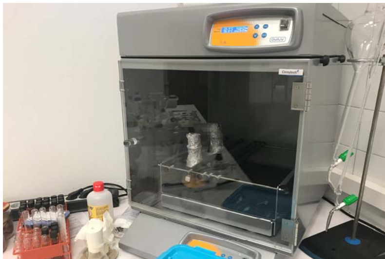
Figura 3-17 Incubador “OVAN” con inóculo y concentrado de nutrientes en su interior
