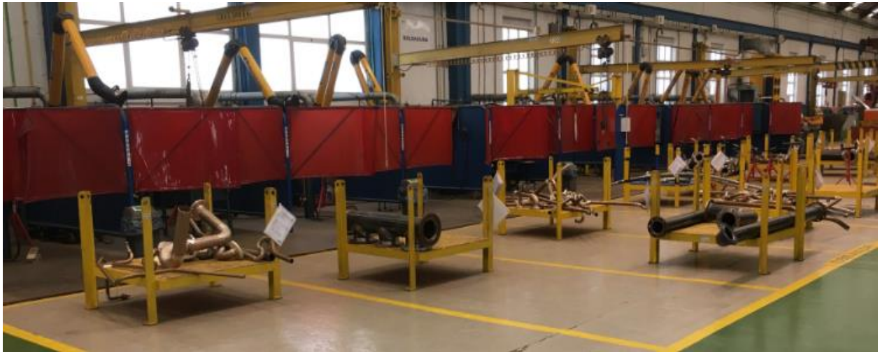
Figura 3-5 Módulos de soldadura.
