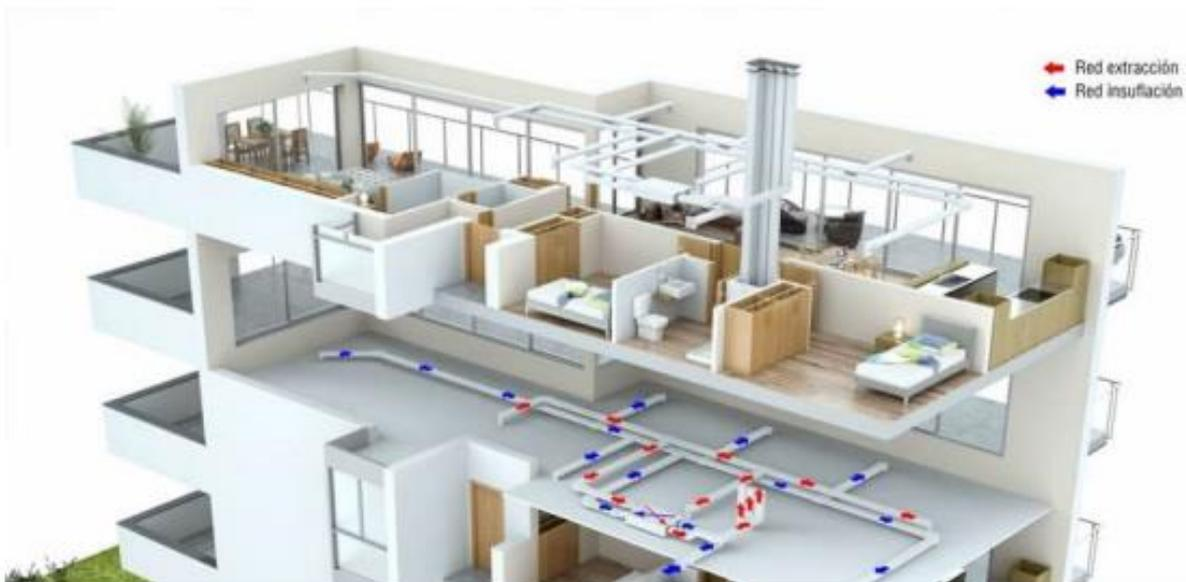
Figura 2-1 Esquema del sistema de ventilación mecánica en una vivienda, según el CTE HS 3 [25].
