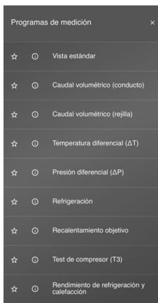
**Figura 3-30 Captura de pantalla de la aplicación Testo**
