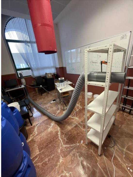
**Figura 3-40 Montaje de extractor con tubo extendido y en gran altura**
