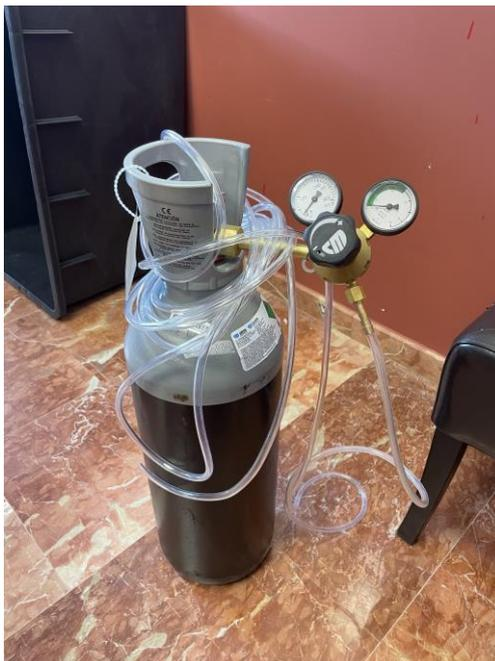
**Figura 3-41 Botella de CO<sub>2</sub> para llenado del despacho**
