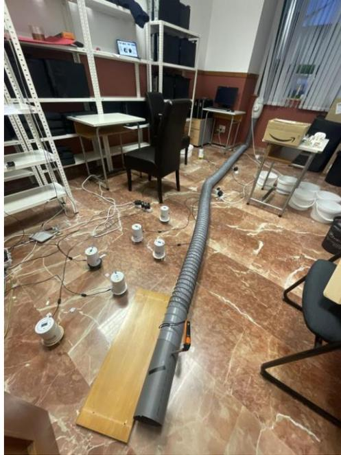
**Figura 3-38 Montaje de extractor con conducto totalmente desplegado**
