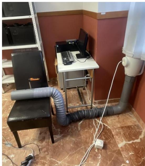
**Figura 3-37 Montaje del extractor con conducto recogido y admisión a doble altura**
