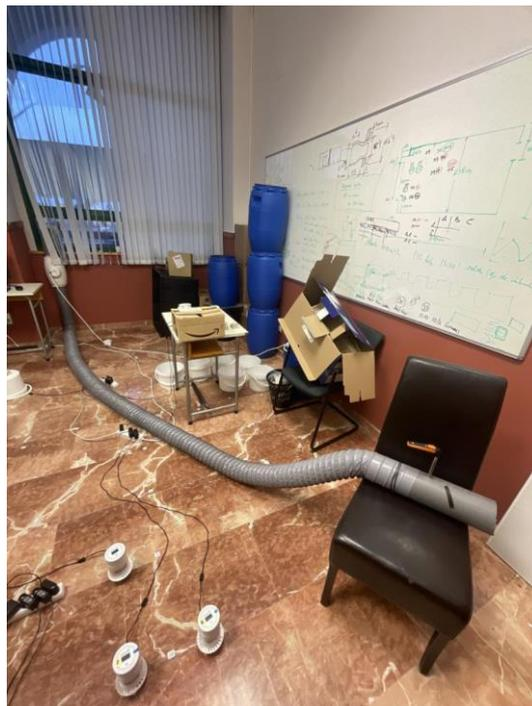
**Figura 3-39 Configuración de extractor con conducto extendido y a doble altura**
