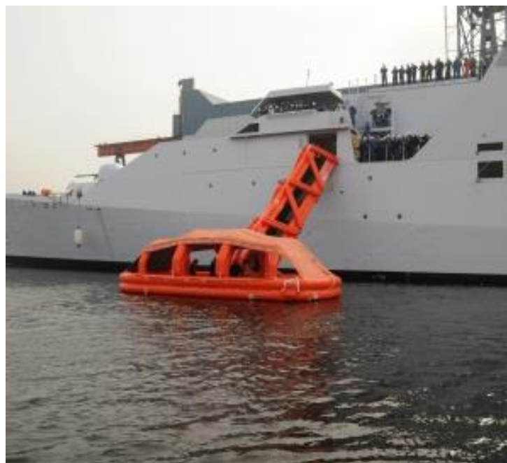
Figura 3-8 Ejemplo de rampa hinchable en buque militar australiano [25].
