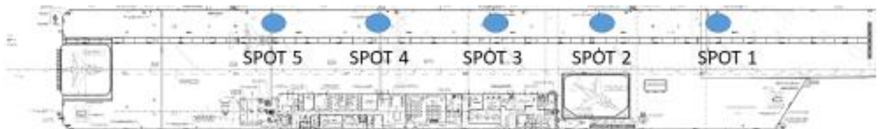
Figura 3-9 Puntos de reunión para abandono de buque en la cubierta 02 del JCI [26].
