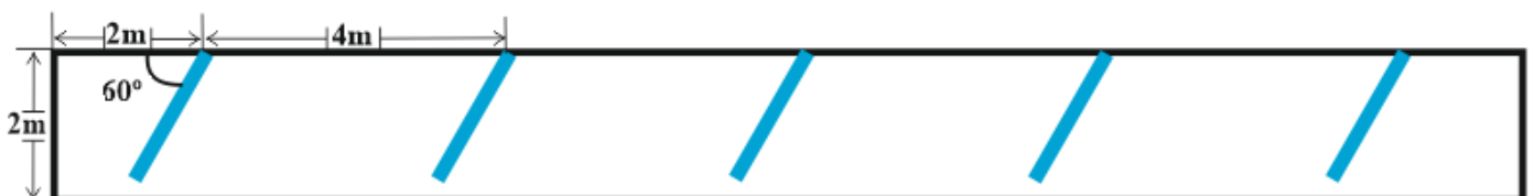
Figura 5-3: Orientación de los captadores (2). Fuente: Propia.
