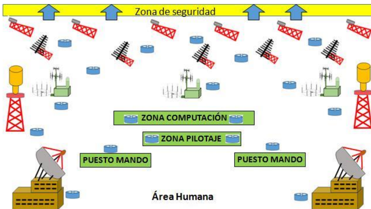
Figura 2-10: En la figura puede verse la distribución de las distintas zonas del Área Humana. En retaguardia, los distintos routers van unidos mediante fibra óptica.
