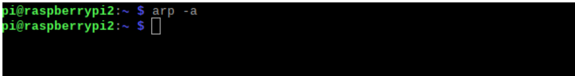
Figura 3-11 Tabla ARP Raspberrypi2 vacía (Autoría propia)
