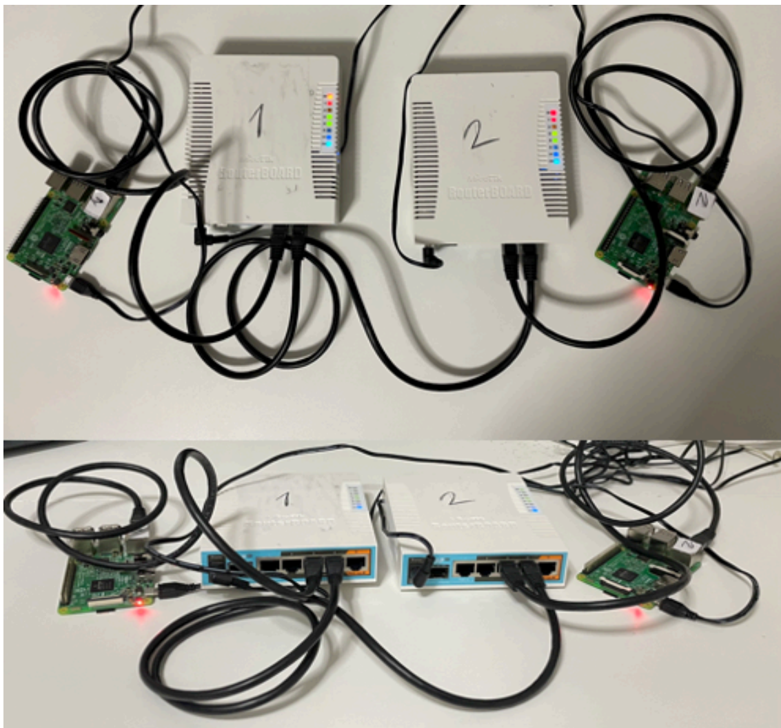
Figura 3-28 Maqueta construida en el laboratorio para la comprobación experimental del protocolo HTTP y configuración estática de enrutamiento (Autoría propia)
