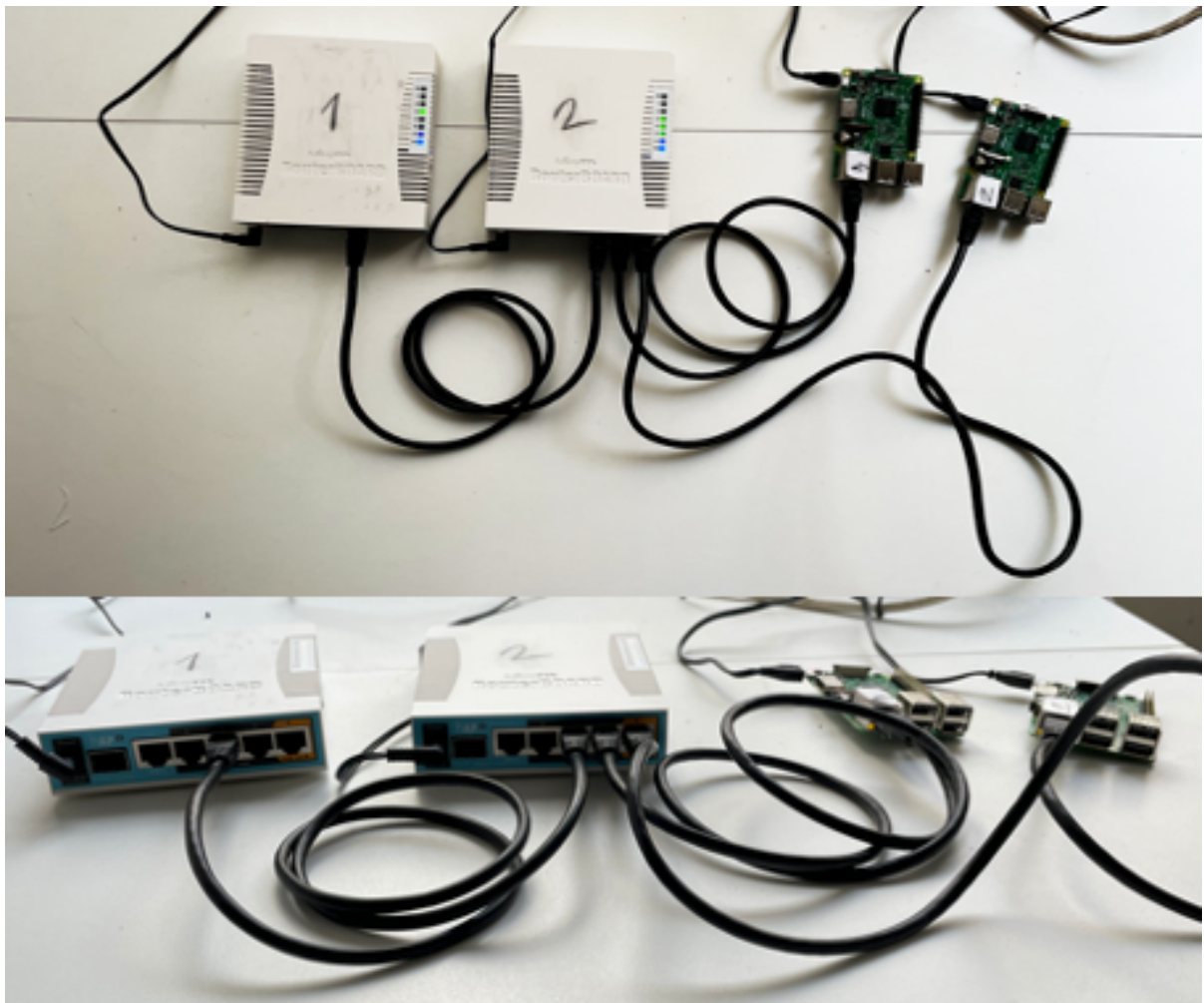
Figura 3-41 Maqueta construida en el laboratorio para la comprobación experimental del protocolo 802.1q (Autoría propia)
