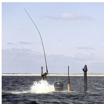
Figura 2-10 Submarino haciendo snorkel para recargar baterías[28]
