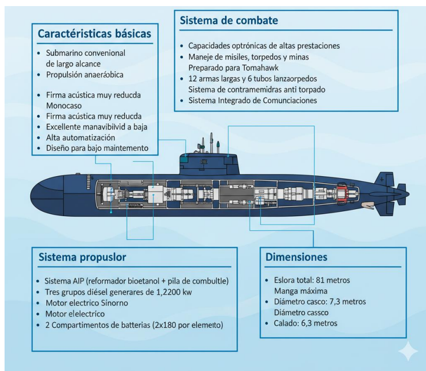
Figura 2-12 Características submarino S-81 Isaac Peral, de Navantia[31]
