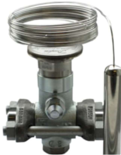
Figura 3-15 Válvula de expansión termostática Danfoss TEA 85-85 para R-717 - Anexo IV: Fichas técnicas de componentes seleccionados
