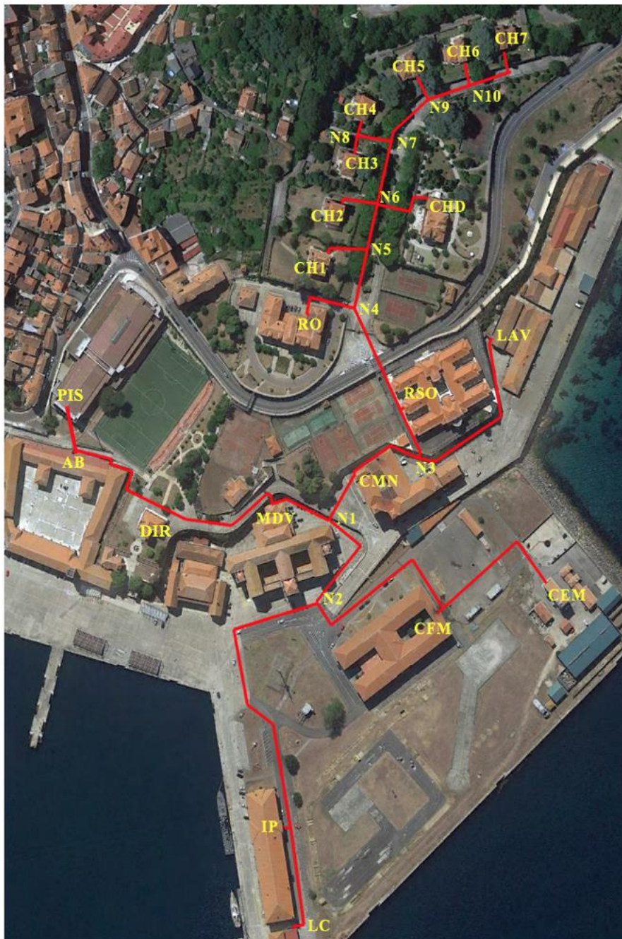
Figura 3-7 Propuesta de trazado de la red de distribución de calor con biomasa (Google Earth)
