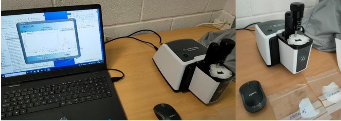
Figura 3-17 Sistema de caracterización FITR. Cortesía LaserON (Uvigo)
