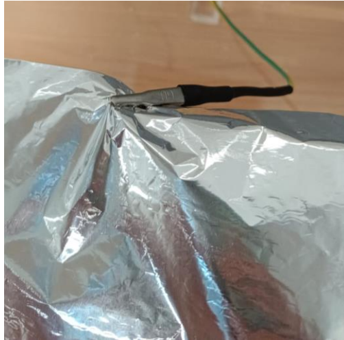
Figura 3-7 Contraelectrodo conectado a papel de aluminio
