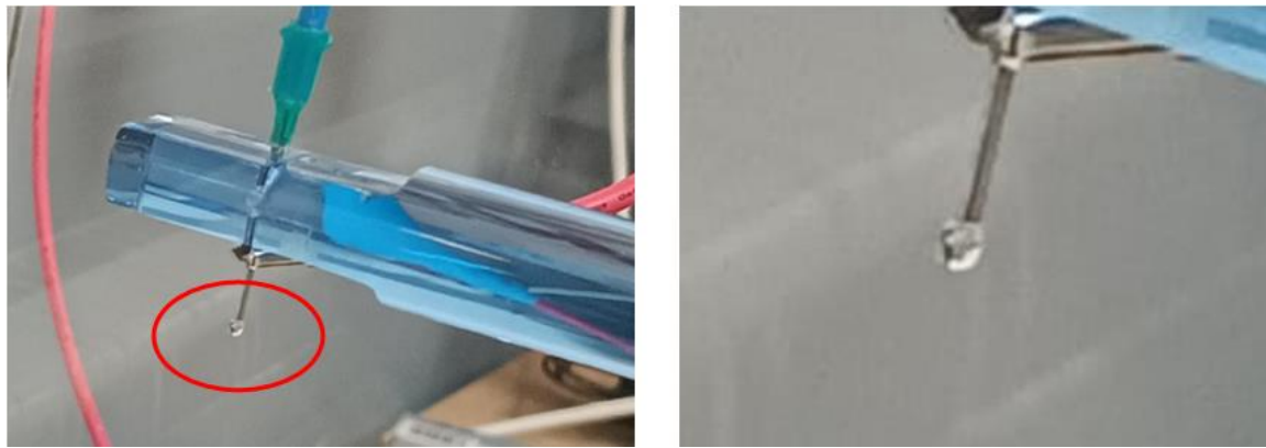
Figura 4-1 Ensayo 13, con un voltaje aplicado de 5 kV
