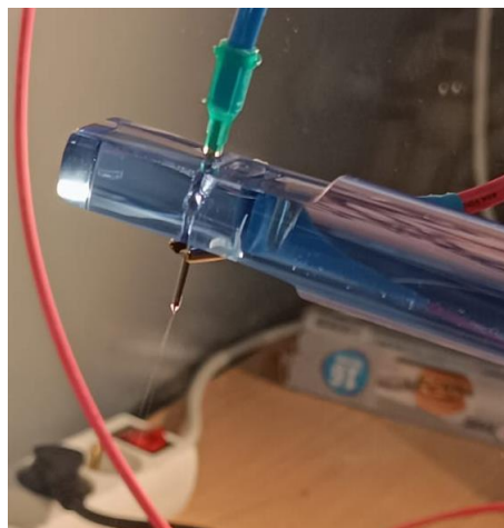
Figura 4-2 Ensayo que demuestra que, a mayor voltaje, mayor elongación
