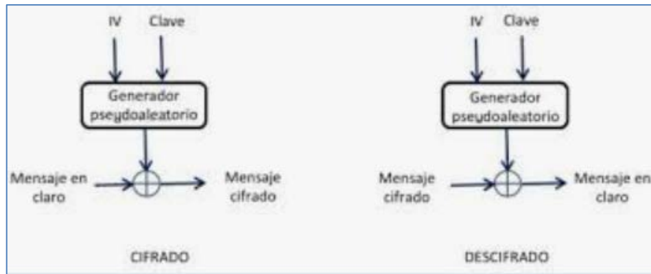
Figura 5-5. Esquema de cifrador de flujo.
