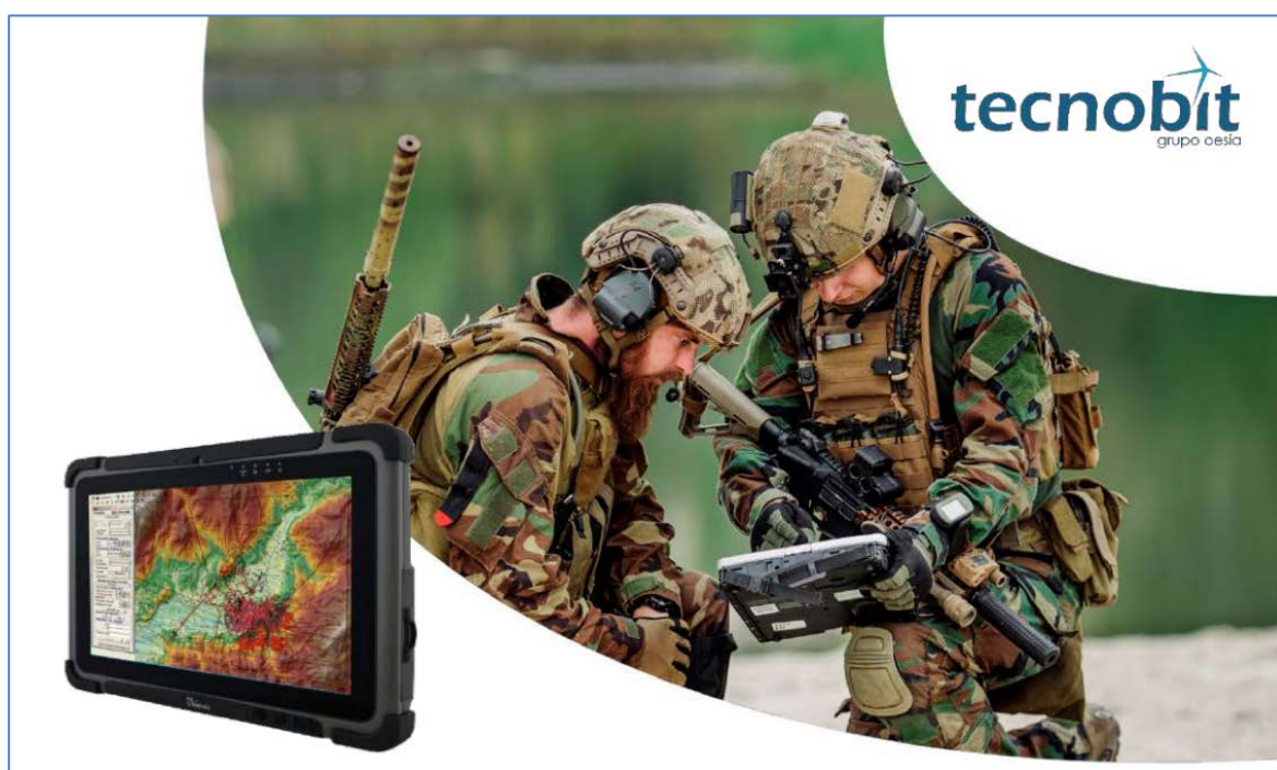
Figura 2-12. Terminal táctico que permite enviar/recibir mensajes VMF. [3]
