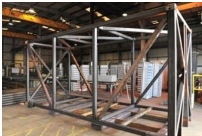
Figura 4-3 - Estructura modular prefabricada (Fuente: Area Data Paraguay S.A.)
