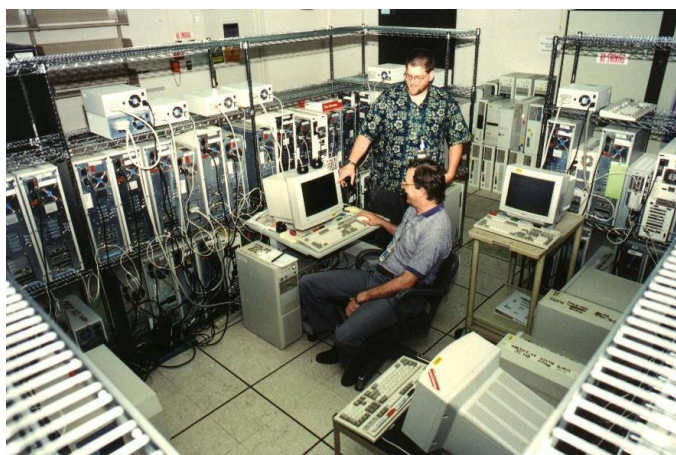
Figura 3-2 - Un clúster de tipo Beowulf [7] ( https://www.climate modeling.org/ )
