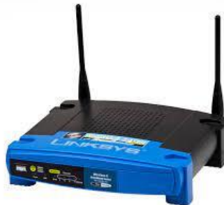
Figura 2-6 Rúter Inalámbrico Linksys WRT54G [15]
