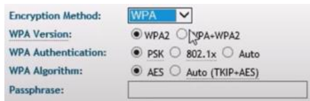
Figura 3-24 Configuración cripto del punto de acceso [97]
