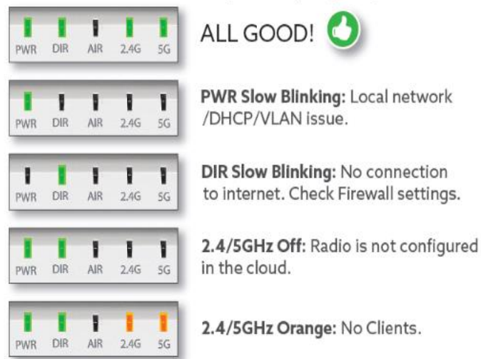
Figura 3- 8 Esquema iluminación de los indicadores frontales Ruckus R610 [71]
