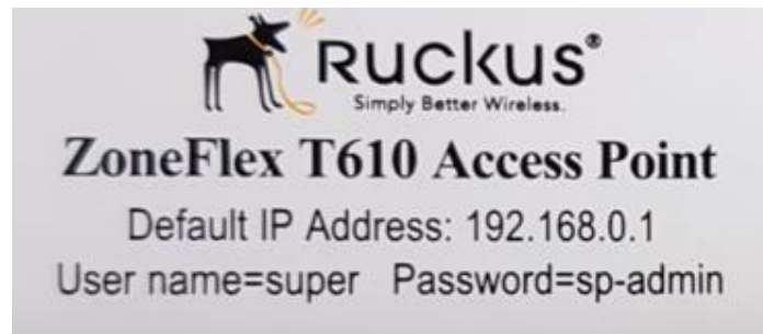
Figura 3-12 Configuración por defecto del punto de acceso en el exterior del punto de acceso [71]
