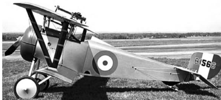
Figura 2-1 Aeronave Nieuport 17 con ametralladora en el plano superior [9].
