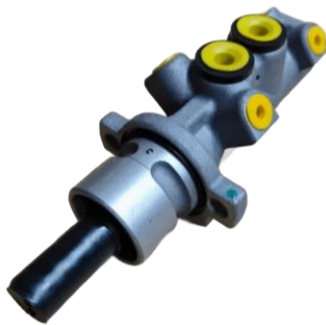
Figura 3-25. Bomba de freno de Peugeot 406 Coupé (fuente: autoría propia)
