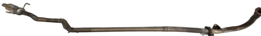
Figura 3-20. Línea de escape acero inoxidable (fuente: autoría propia)
