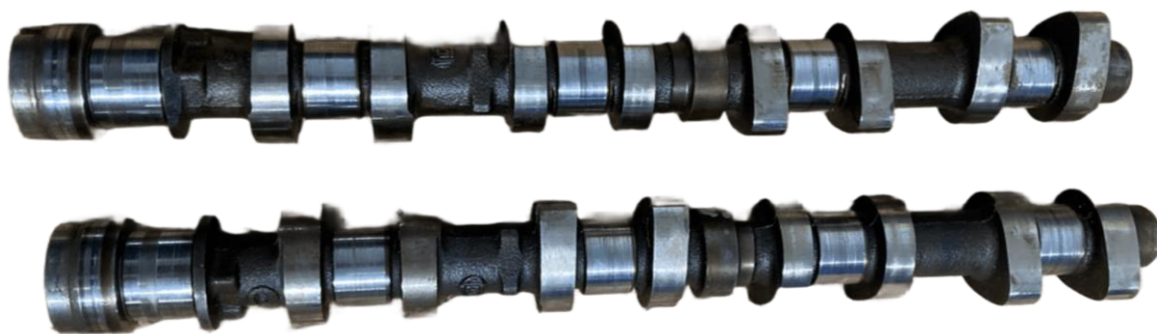
Figura 3-11. Árboles de levas del motor NFX (fuente: autoría propia)
