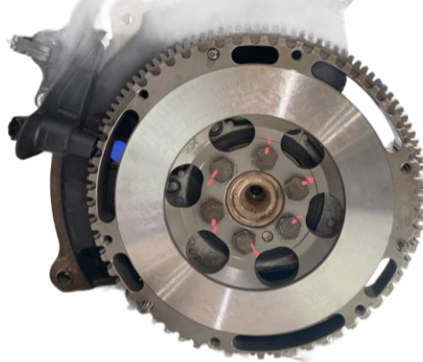
Figura 3-21. Volante de inercia aligerado (fuente: autoría propia)
