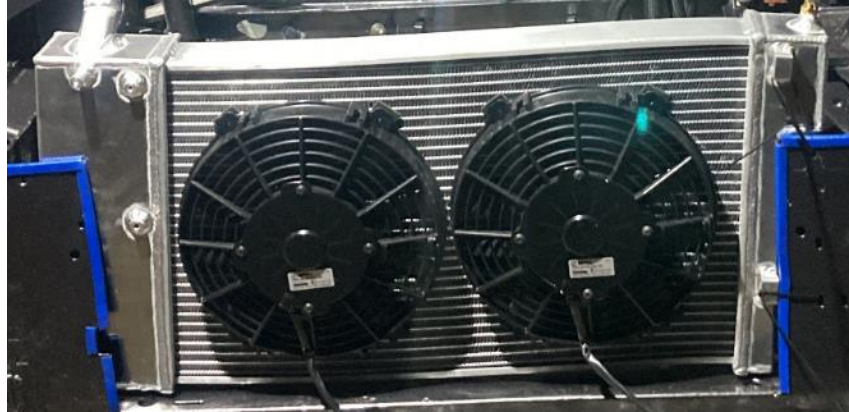
Figura 3-31. Radiador de aluminio junto con electroventiladores (fuente: autoría propia)
