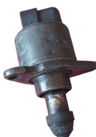
Figura 3-17. Válvula de ralentí defectuosa (fuente: autoría propia)
