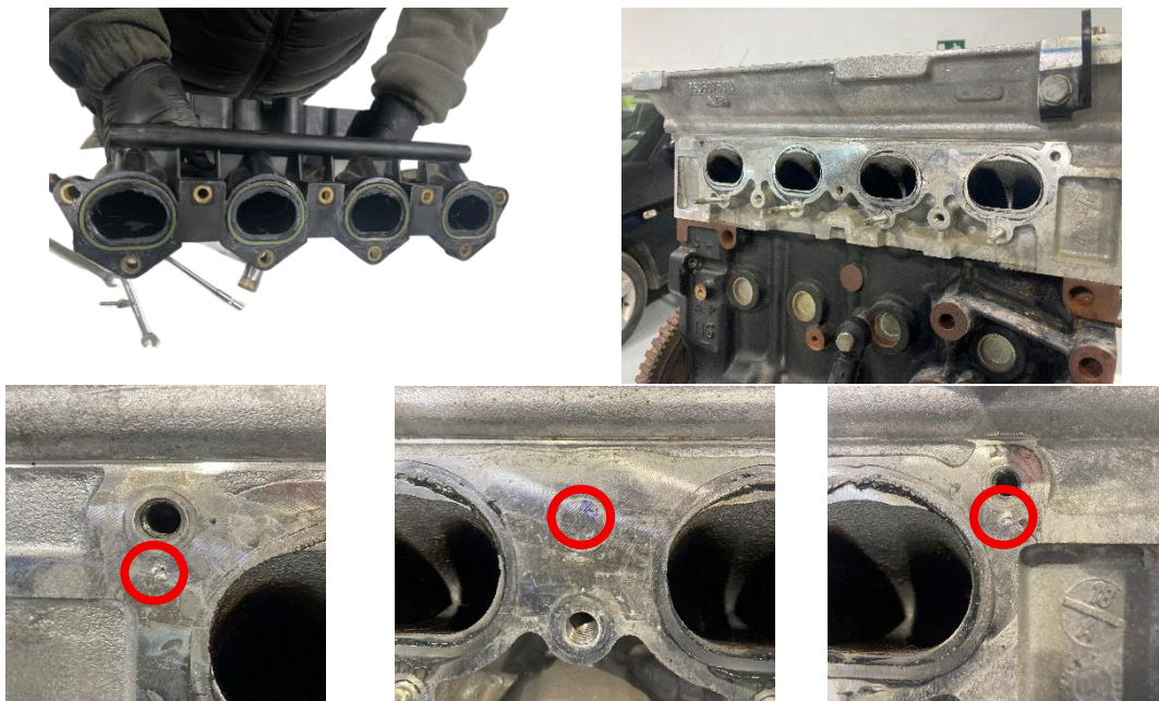
Figura 3-16. Adaptación del cuerpo de admisión (fuente: autoría propia)
