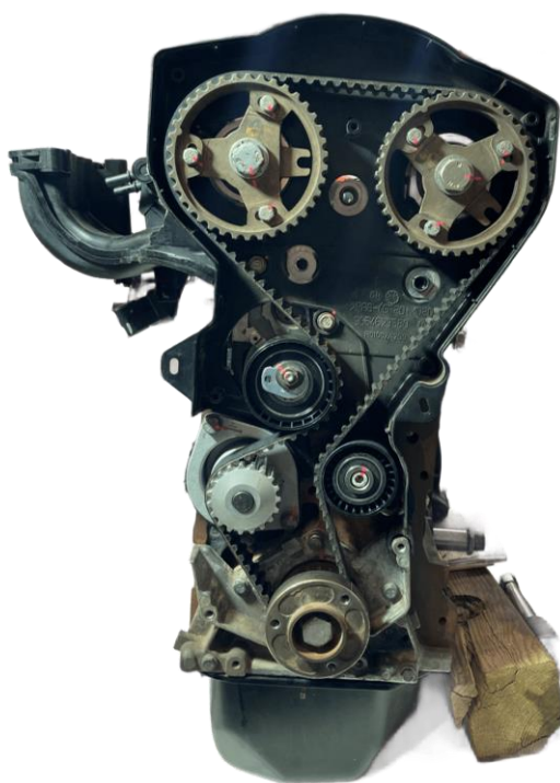
Figura 3-14. Distribución montada y marcada (fuente: autoría propia)
