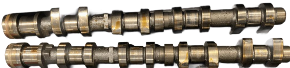
Figura 3-9. Árboles de levas del motor NFU (fuente: autoría propia)
