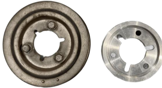
Figura 3-22. Polea de accesorios original y modificada (fuente: autoría propia)
