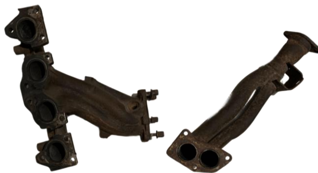
Figura 3-19. Colectores de escape 4-2-1 (fuente: autoría propia)
