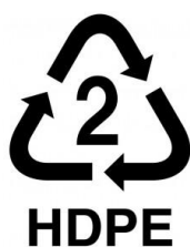
Figura 2-9 Símbolo de identificación del polietileno de alta densidad ( www.re-cicla.com )
