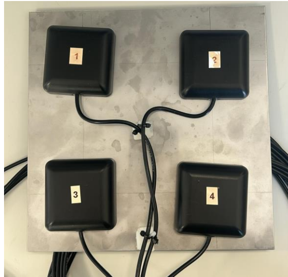
Figura 4-23 UCA de 4 elementos separados a \lambda/2
