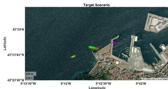
Figura 6. Posicionamiento en coordenadas latitud/longitud de los blancos detectados en los ejemplos anteriores para t=0 \dots 60 s. Los círculos rojos y amarillos representan los dos blancos alejándose y acercándose al radar identificados en MFN. Los círculos verdes representan el blanco detectado en SFN.
