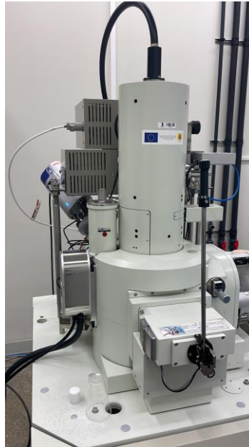
Figura 3-8 Microscopio electrónico de barrido de emisión de campo. Modelo JSM-6700F
