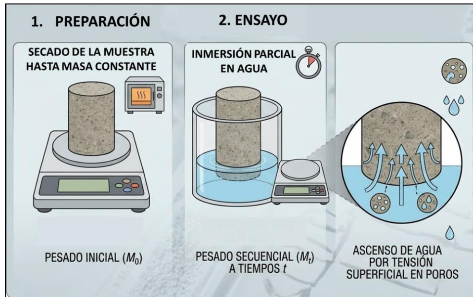
Figura 3-5 Etapas del ensayo de absorción capilar. (Imagen generada con Gemini)
