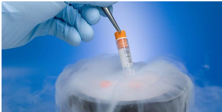
Figura 2-7 Manipulación de muestra en ambiente criogénico [36].
