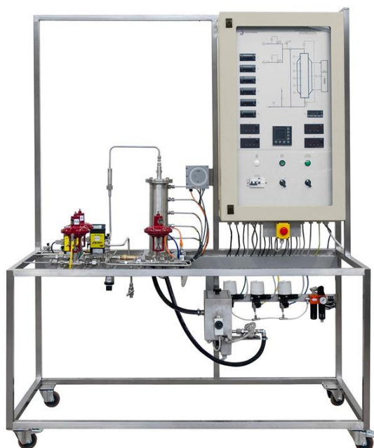
Figura 2-5 Sistema experimental de adsorción en lecho fijo para el estudio de captura de CO 2 en fase gas [34].
