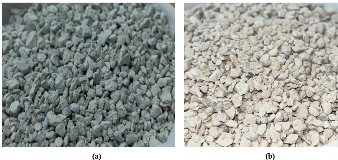
Figura 2-9 (a) Zeolita sin calcinar y (b) Zeolita calcinada a 650 °C.
