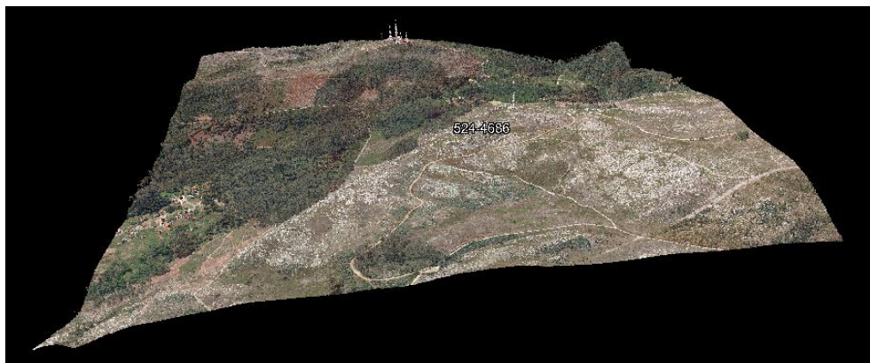
Figura 3-10 Ejemplo de una nube de puntos de la zona de estudio visualizada en RiSCAN Pro
