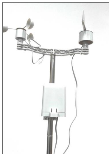
Figura 4-46: Distribución de sensores de la estación
