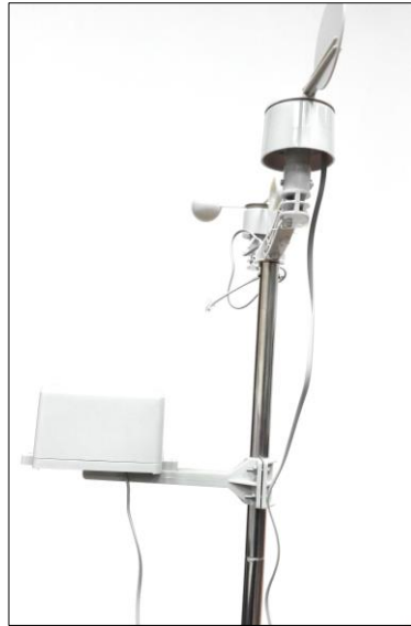
Figura 4-47: Distribución de sensores de la estación 2
