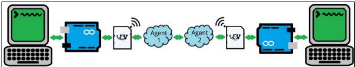
Figura 4-60: Esquema de funcionamiento de la tarjeta Electric Imp
