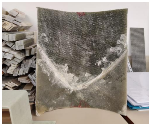
Figura 2-9 Pieza de estructura en aramida (Kevlar) para ensayo en laboratorio.
