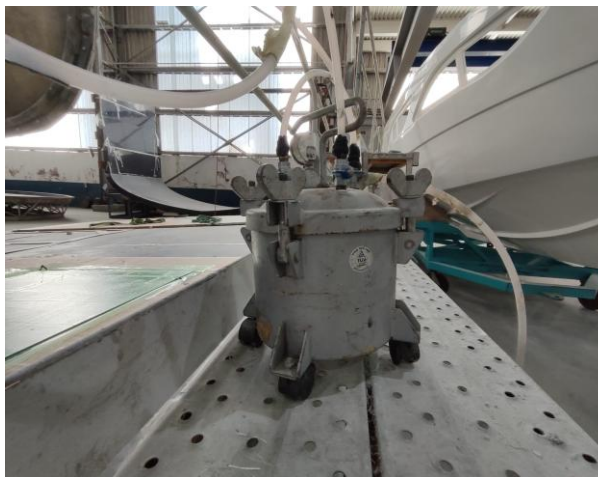
Imagen 7. Recipiente auxiliar asociado a la instalación de vacío.
