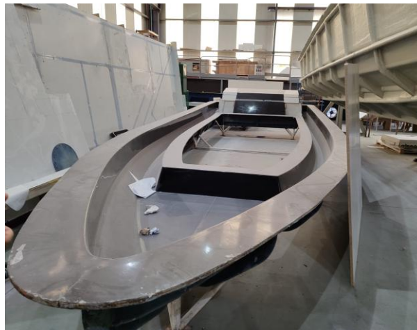
Imagen 2. Molde de cubierta en el área de fabricación de materiales compuestos.
