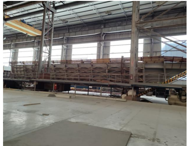
Imagen 10. Molde de gran eslora dispuesto para la fabricación de una estructura naval.
