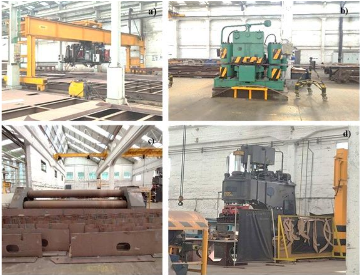
Figura 3-1 Composición de maquinaria típica de astillero de construcción en acero.
