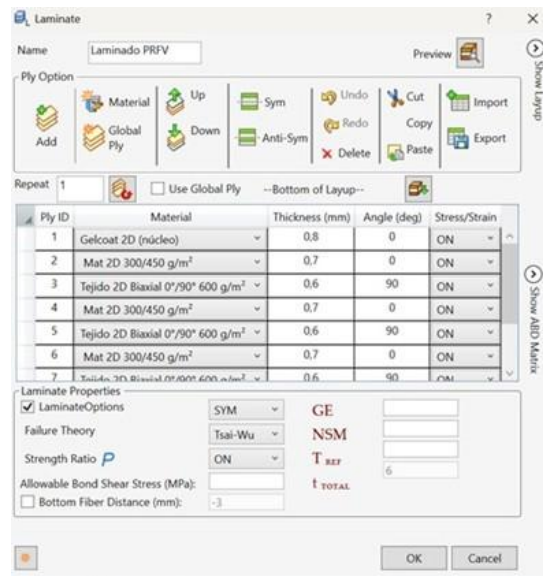
Figura 4-7 Configuración del laminado PCOMP en Nastran In-CAD.
