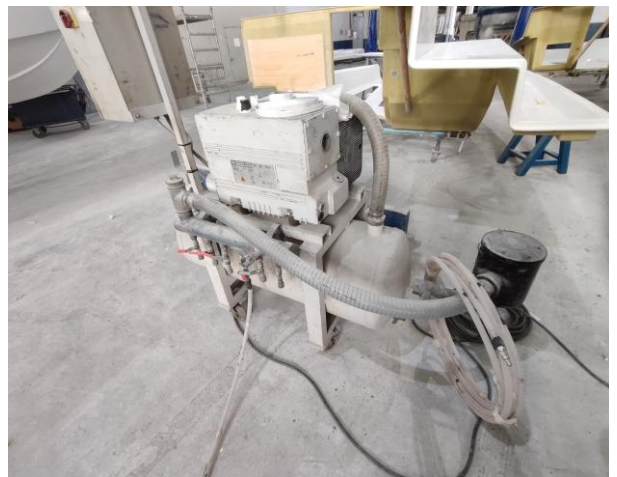
Imagen 8. Bomba de vacío utilizada durante operaciones de infusión.
