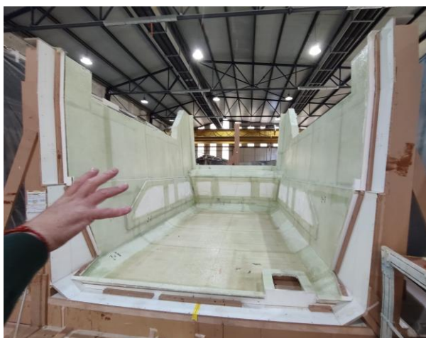
Imagen 3. Molde de casco de PRFV preparado para operaciones de laminación.
