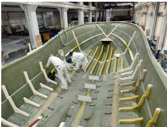
Figura 2-10 Conformado de perfil de casco en material compuesto por laminado manual
