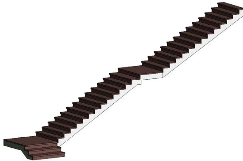
Figura 3-61 Escalera de pañol de almacenamiento de embarcaciones de vela ligera modelada
